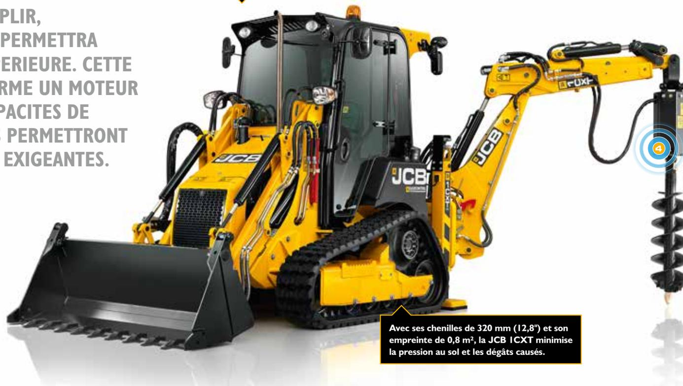
Avec ses chenilles de 320 mm (12,8") et son empreinte de 0,8 m<sup>2</sup>, la JCB ICXT minimise la pression au sol et les dégâts causés.
