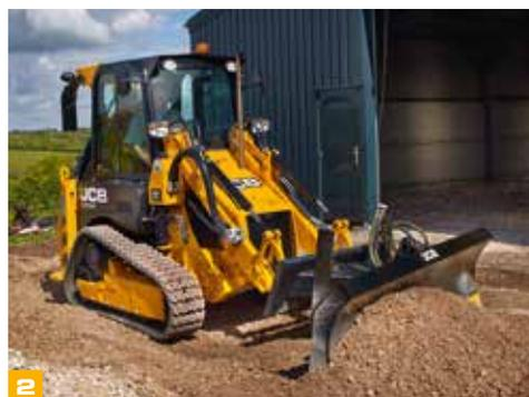
**3** Si vous souhaitez utiliser des équipements à haut débit, optez pour le circuit auxiliaire à haut débit de 100 L/min.
